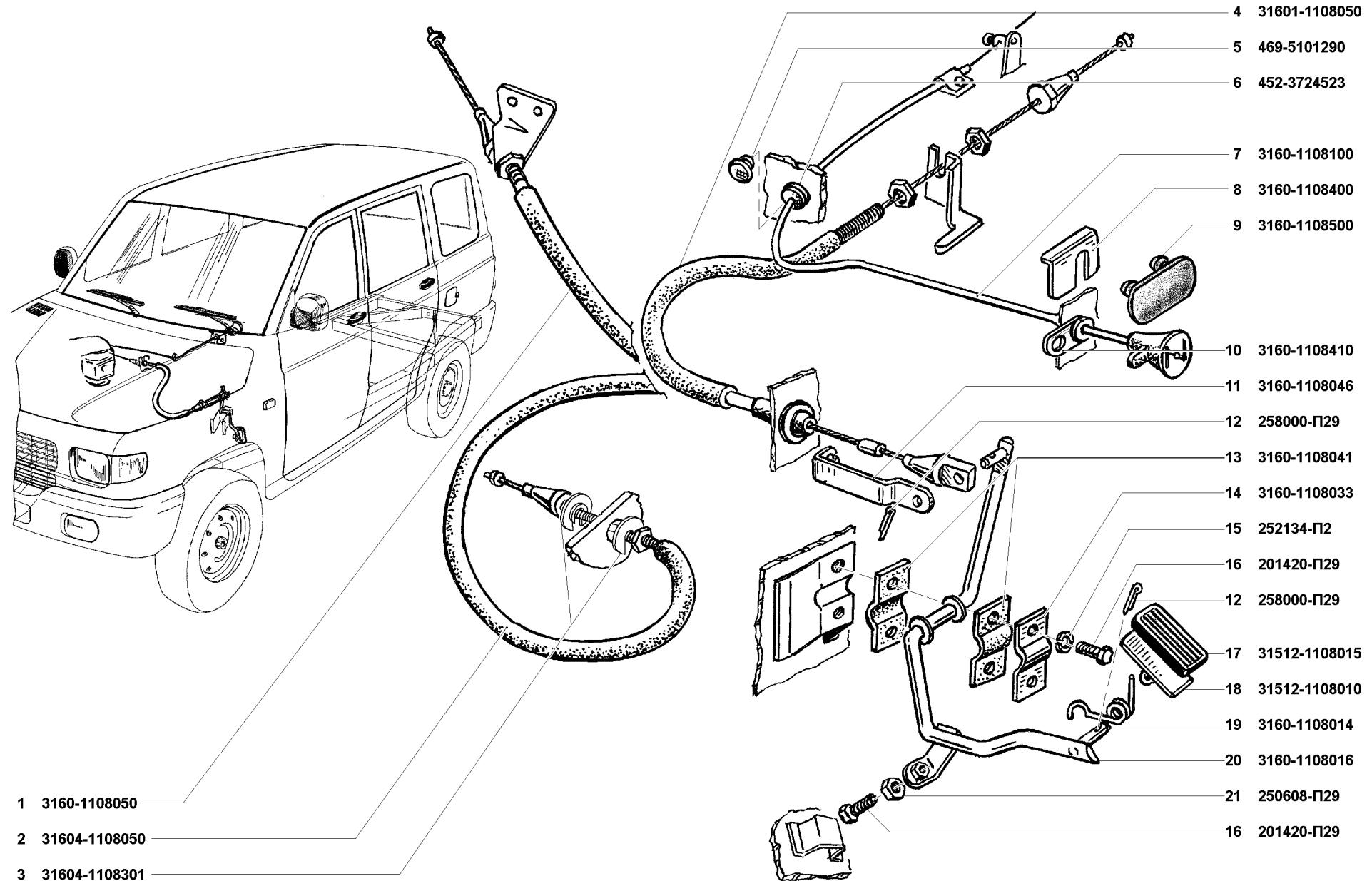
Рис. 28. Привод управления дроссельной и воздушной заслонками (1108)
